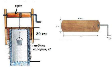
1. При поднятии воды из колодца, диаметр ворота которого равен 20см, сделали 20 оборотов ручкой. Высота деревянного сруба над землей -80 см.
